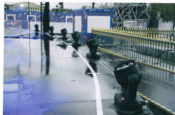
Les nouveaux Mac Aura XIP ont bien rempli leur rôle malgré la pluie, forts de leur indice IP54.
