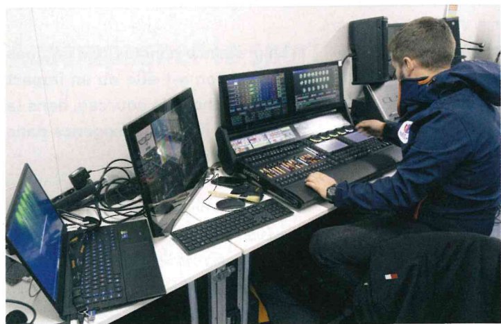
La régie en semi-aveugle de Thomas. Un Wysiwyg à gauche pour la visualisation 3D en direct de son kit, et un retour des caméras lui permettant de monitorer ses niveaux d'intensité.
