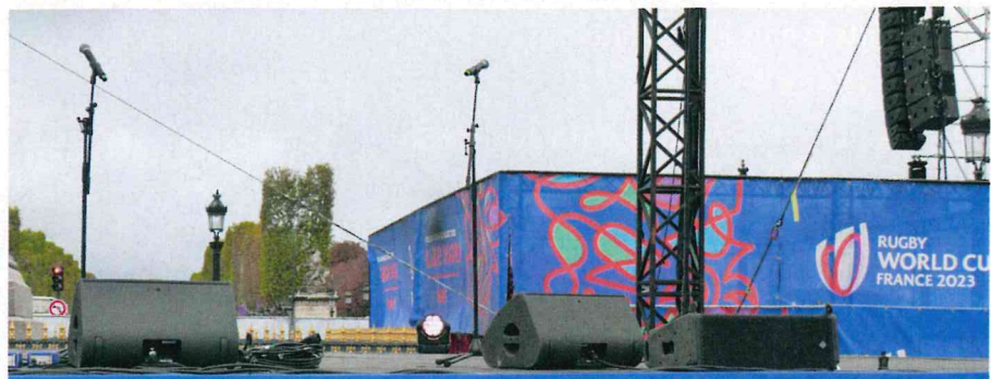
En nez de scène, une des six enceintes ViRAY utilisées en lip-fill. On remarque aussi les deux retours L-Acoustics X15.
